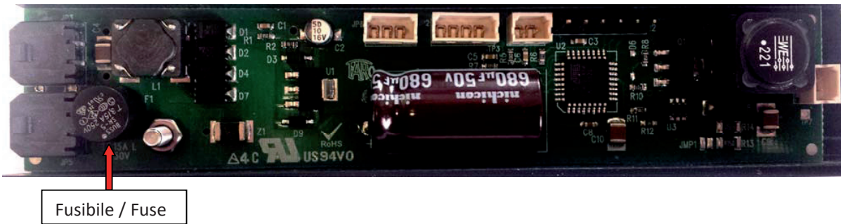
Circuit électrique dans le bras arrière
