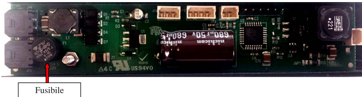
Circuito eléctrico en el brazo trasero
