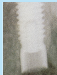
FRESA AD ARTIGLIO A CONTATTO CON LA VITE ROTTA
